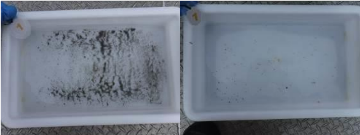
Figur 6: Bilder som viser sedimentet fra stasjon 1 før og etter siling. Sedimentet besto av noe sand på fjellbunn. Foto: Aqua Kompetanse AS.
