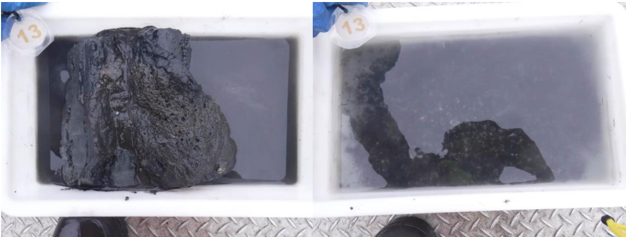
Figur 18: Bilder som viser sedimentet fra stasjon 13 før og etter siling. Sedimentet besto av Silt og sand med noe grus.. Foto: Aqua Kompetanse AS.
