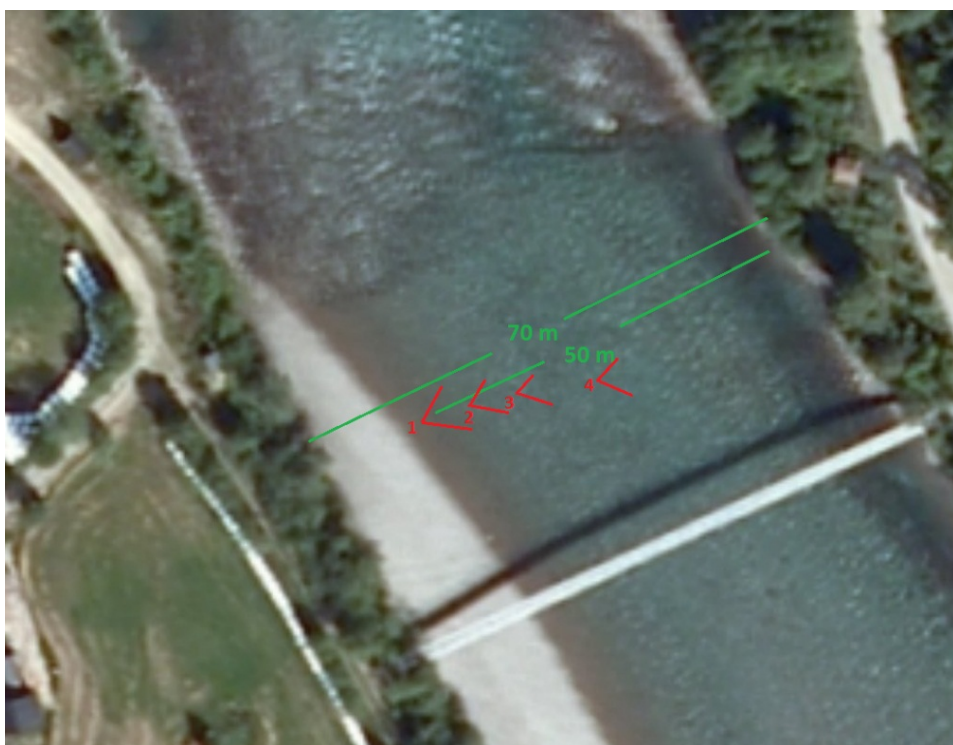
Figur 3. Kameraplassering i videoovervåkingsprosjektet ved Børånes i Saltdalselva i 2010. Total bredde på elva ved høyeste og laveste vannføring er angitt med grønn markering. Bildet viser elva ved middels vannføring for overvåkingsperioden.
